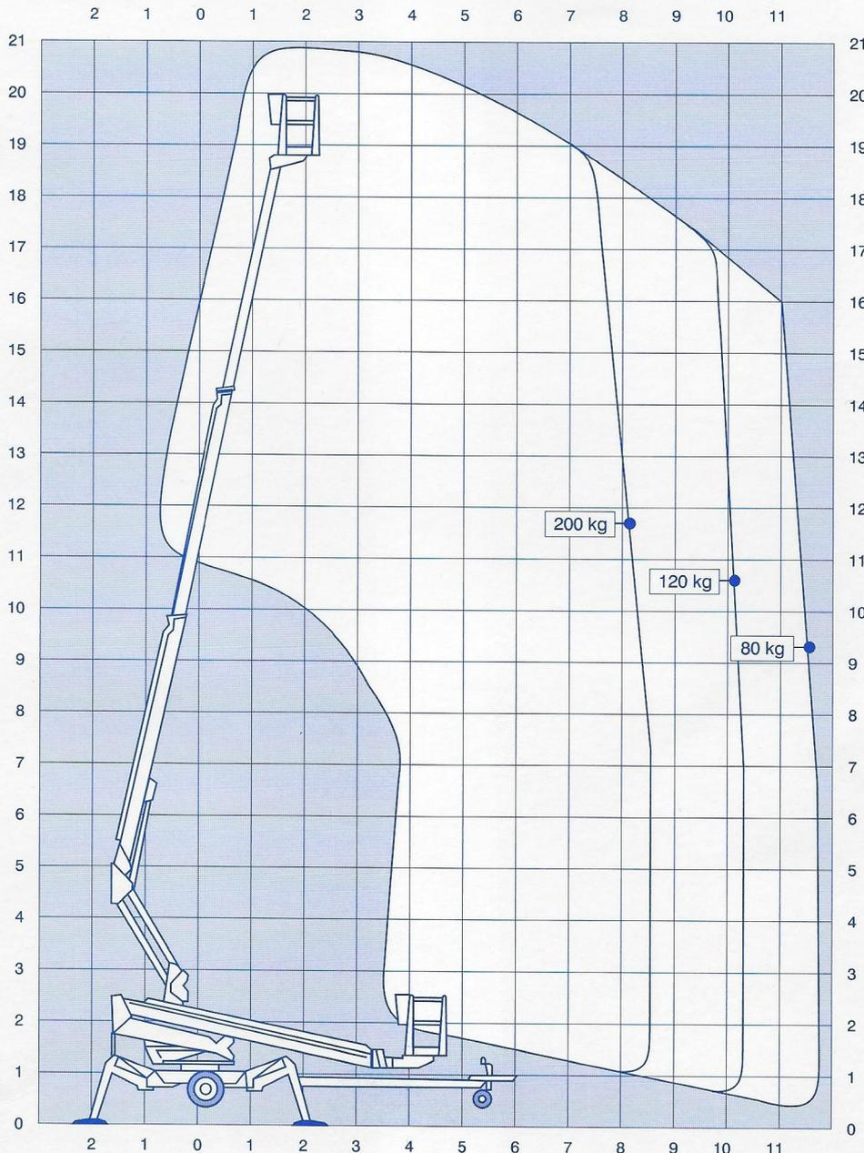
**Maximale Arbeitshöhe** 21,00 m
